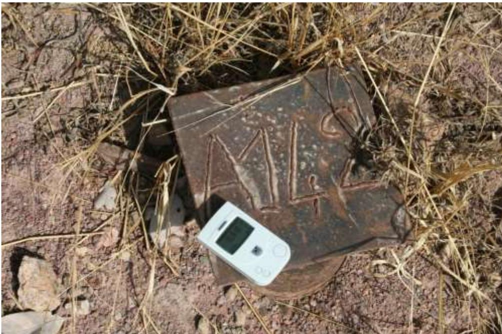
*Test avec un compteur Geiger sur un forage test d'uranium à Madajang (Baldal Oyamta)*
